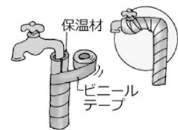
＜図＞むき出しの水道管の防寒方法
