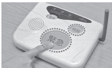
緊急通報装置
