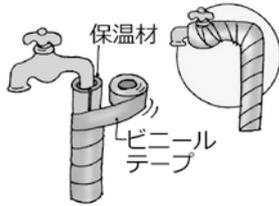
＜図＞むき出しの水道管の防寒方法
