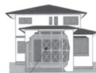
耐震シェルター
