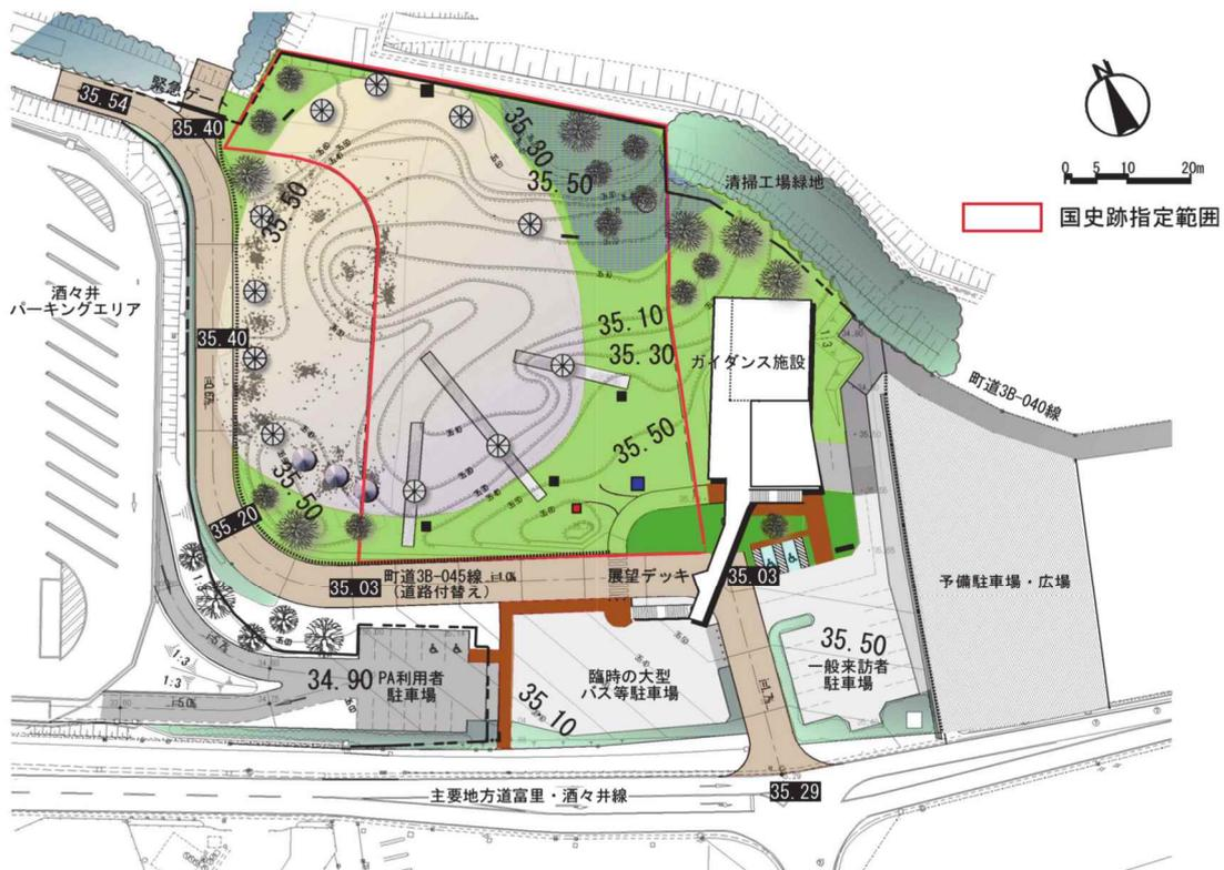
図 4 5 造成計画平面図（造成コンタと高さ）
