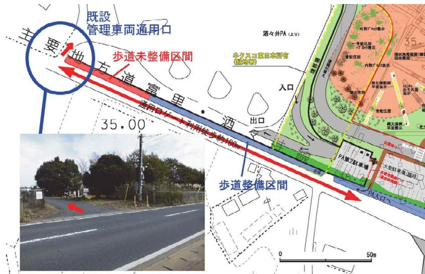
図4 2 動線計画図（上）と管理車両通用口の位置図（下）
